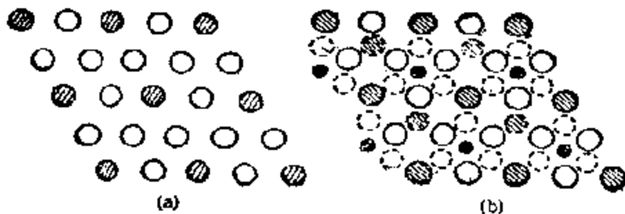
图 7-20 (a) MX_2 密置层(有阴影的为 M, 其余为 X); (b) 两个 MX_2 密置层堆积时形成 X_6 八面体孔隙(用●表示)
