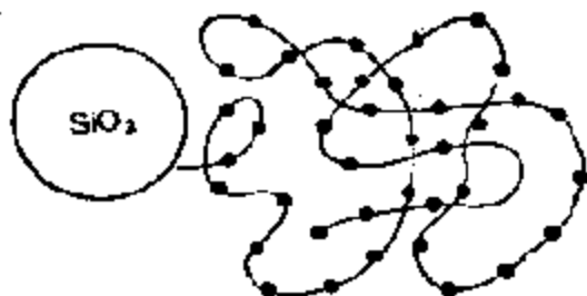
图 6-52 锚定在无孔硅胶球上的大分子催化剂示意图
