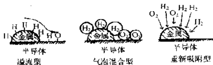
图 12-37 在金属化的半导体光催化剂上, H 2 和 O 2 重新反应的可能机理
