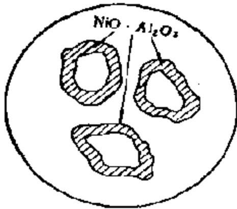
图 7-149 在 \text{Al}_2\text{O}_3 粒子外边生成的 \text{NiO}\cdot\text{Al}_2\text{O}_3
