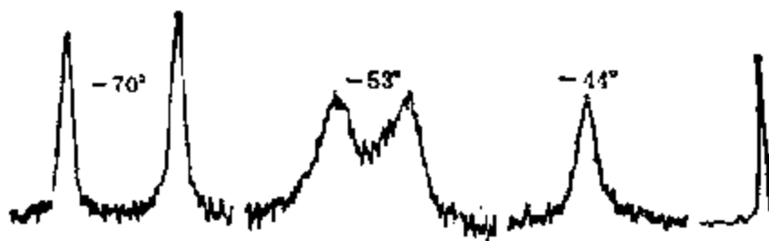
图 5-30 顺、反- [\eta^5-C_5H_5Fe(CO)_2]_2 在几个温度下的 ^1H nmr 谱
