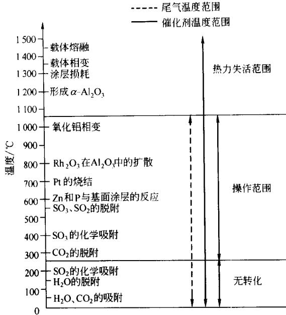
图 13-31 三效催化剂的某些失活现象与催化剂温度的相关性概图
