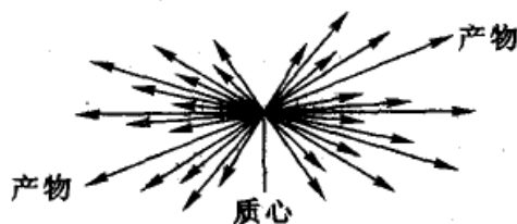
图 12.14 形成中间络合物的散射示意图
